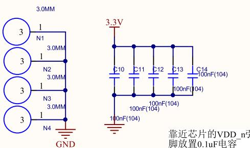
靠近芯片的VDD\_n引脚放置0.1uF电容
